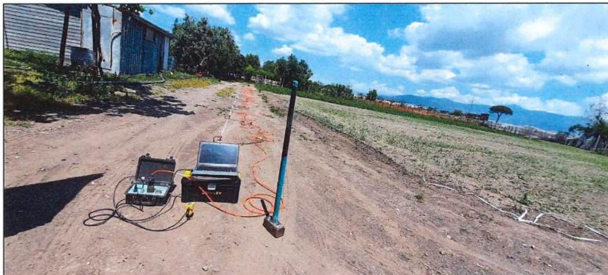
Foto 1: Stendimento di 12 geofoni a frequenza di 4.5 Hz.
